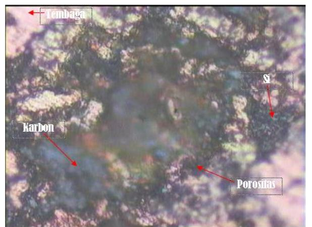
Gambar 11.  $T_s=800^{\circ}\text{C}$ ,  $P=300\text{ MPa}$ , 500X. Pada suhu lebih tinggi dengan tekanan sama porositas makin mengecil
