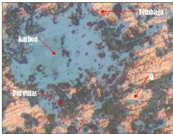
Gambar 8.  $T_s=700^{\circ}\text{C}$ ,  $P=200\text{ MPa}$ , 500X menunjukkan pencampuran tembaga dan karbon yang saling mengisi dan beberapa porositas.
